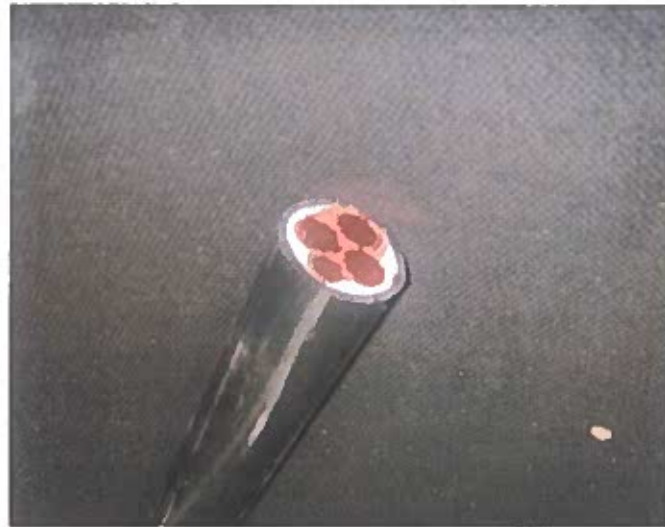
Câbles BT isolés au PR 3x 95 + 50
